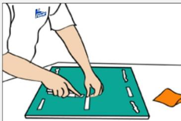
2. É preciso manter um distanciamento de 3 mm entre o espelho e a parede, permitindo o escoamento da umidade. Isso pode ser feito com calços de apoio e espaçadores.
