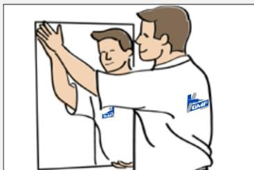
4. Optando-se por utilizar calços de apoio e espaçadores, o espelho é ajustado já na parede para sua melhor centralização por um período de até 10 minutos.
