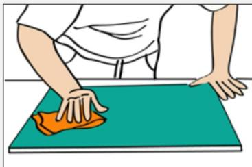
1. Verifique se a superfície onde será feita a colagem está limpa e nivelada. Limpe o lado pintado do espelho com um pano macio umedecido em álcool. Passe um pano seco para retirar o excesso.
